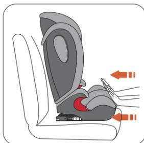
1. Positionnez le siège Star-Fix sur le siège du véhicule. Poussez le siège vers le siège avant jusqu'à ce qu'il soit appuyé correctement sur dossier du siège arrière.
