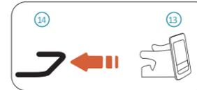
1. Installez les guides d'insertion ISOFIX 13 sur les points de fixation ISOFIX du véhicule 14.
