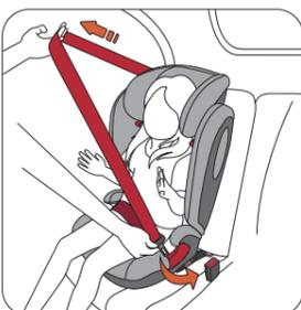
5. Positionnez la ceinture 3 points du véhicule face à l'enfant, et bloquez la ceinture dans la boucle du véhicule, jusqu'à entendre un clic.
