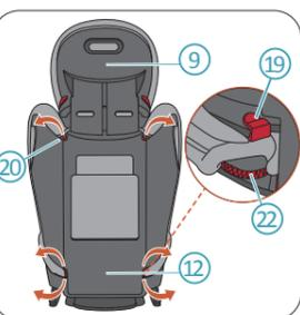
1. Ajuste o apoio da cabeça **9** para a posição mais alta. Liberte os ganchos da capa **19** e as bandas elásticas **20** atrás do apoio das costas **12**. Liberte os ganchos da capa **21** no lado frontal do apoio das costas. De seguida, retire a capa do apoio das costas.
