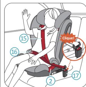
6. Coloque a secção do cinto do ombro **15** e secção do cinto do colo **16** do lado da fivela do cinto do assento do veículo **17** no guia do cinto do colo vermelho **2** da almofada do assento **7**.
