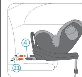
**3.** Coloque o assento infantil no assento do veículo e aponte os dois conectores ISOFIX **4** para os pontos de fixação ISOFIX **21** no assento do veículo.
