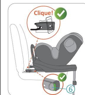
**4.** Pressione um conector ISOFIX para encaixá-lo no ponto de fixação ISOFIX com um som de clique. Repita a ação do outro lado para engatar os dois conectores ISOFIX.
