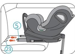
2. Placez le siège enfant sur le siège du véhicule et alignez les deux connecteurs ISOFIX (5) sur les points d'ancrage ISOFIX (23) du siège du véhicule.
