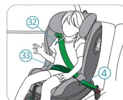
2. Placez la section de la ceinture d'épaule (32) et la section de la ceinture de bassin (33) du côté de la boucle dans le guide de ceinture de bassin (4) de la base.
