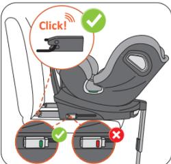
3. Poussez un connecteur ISOFIX pour le verrouiller sur le point d'ancrage ISOFIX avec un clic. Répétez l'action de l'autre côté pour verrouiller les deux connecteurs ISOFIX.
