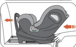
4. Poussez fermement le siège enfant vers le dossier du siège du véhicule aussi loin que possible jusqu'à ce qu'il repose contre le dossier du siège du véhicule.
