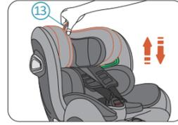
Tirez et maintenez l'anneau d'ajustement du repose-tête (13) à l'arrière du repose-tête pour libérer le repose-tête. Déplacez le repose-tête à la hauteur correcte, plaçant les guides de la ceinture au-dessus des épaules de l'enfant. Ensuite, relâchez l'anneau pour verrouiller la hauteur du repose-tête.
