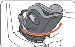
5. Ensuite, exercez une force pour le pousser fermement vers l'arrière des deux côtés, assurant ainsi une connexion plus sécurisée entre le siège de sécurité pour enfant et le siège du véhicule.
