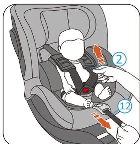
5. Potiahnite nastavovač 5-bodového postroja (12), až kým postroj (2) pevne nezaistí vaše dieťa.
