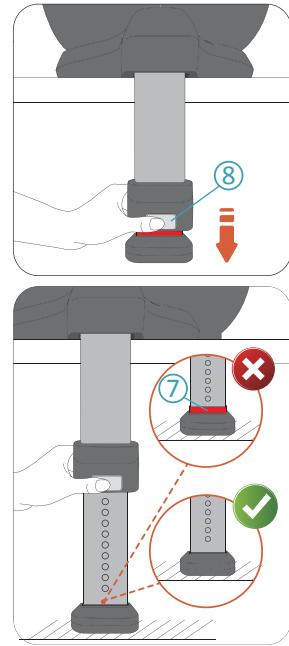
**6.** Натиснете бутона за освобождаване на опорния крак **8** за да освободите опорния крак **9** докато не допре пода на автомобила.
